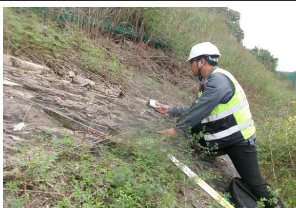
절리면 경사/경사방향 측정
